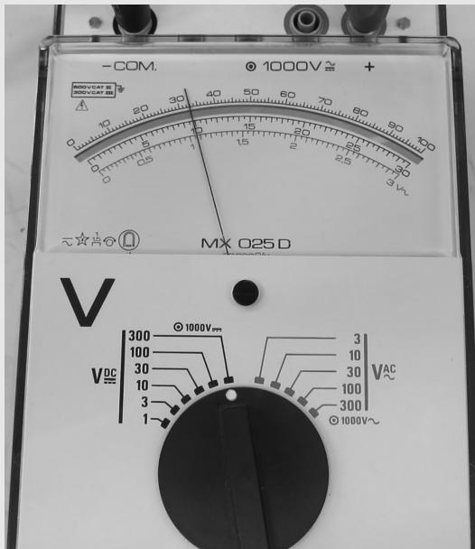
Figure 1.1 – Multimètre - mesure de tension
