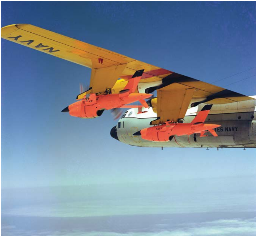
À DROITE Avion Lockheed DC-130 transportant sous ses ailes deux drones cibles BQM-345 Firebee.
