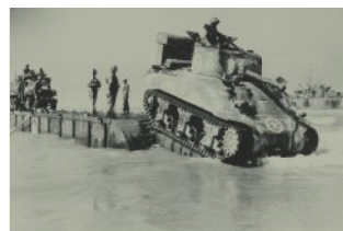
Les débarquements de Sicile et d'Italie sont l'occasion de tester le matériel pour acheminer sur la plage des véhicules lourds, comme des chars Sherman ou des camions GMC, grâce à des pontons artificiels, comme ici en Sicile, le 10 juillet 1943.
