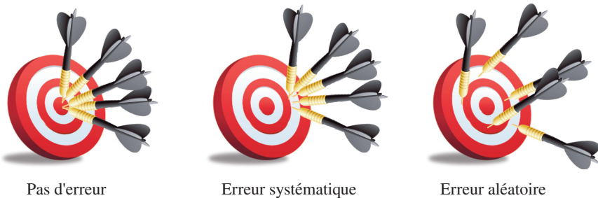
Figure 1.2 ▶ Illustration de l'erreur systématique et aléatoire lors d'une mesure.
