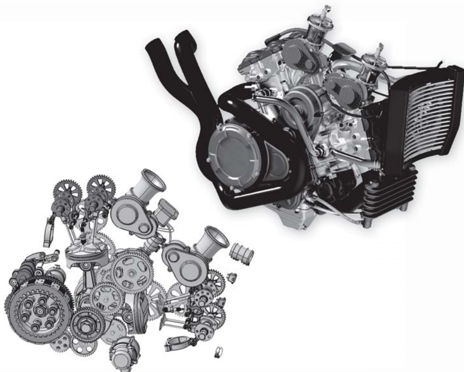
Figure 1.2 Vue technique (utile pour les concepteurs) et rendu réaliste (pouvant être utilisé à des fins publicitaires, marketing...) d'un moteur réalisés à partir d'un même modèle CAO.
