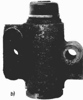
Fig. 19.4. Correcteur de freinage. (Photo Jeanbor © Photob.)
